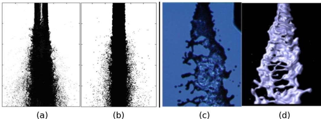
Fig 2 : Comparaison exp./num. : injection diesel (a)-(b), injecteur triple disque (c)(d) [8]
