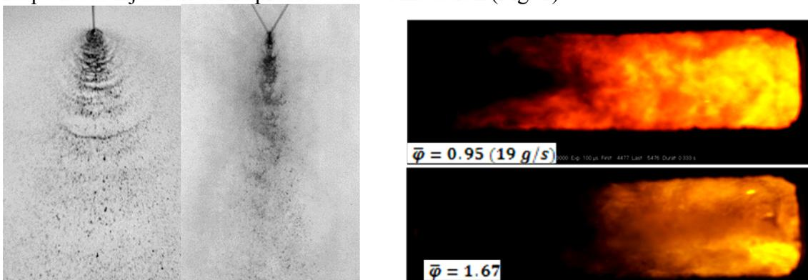
**Fig 1 :** Pulvérisation par jet impactant et visualisation de la combustion stabilisée
